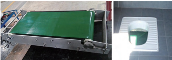
图3 机械传输式源分离免水冲厕所
