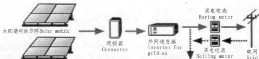
图4 家用太阳能并网发电系统示意图
