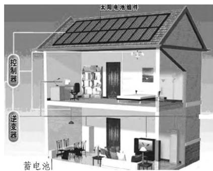
图7 家用太阳能发电系统设计和安装示意图
