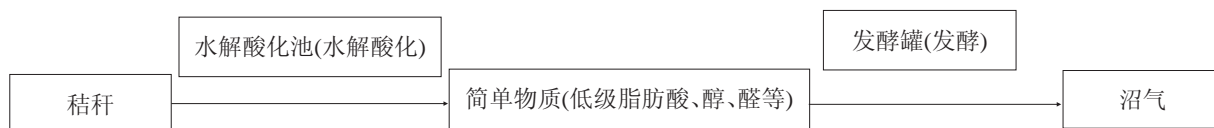
图 2 秸秆产沼气的工艺示意图
