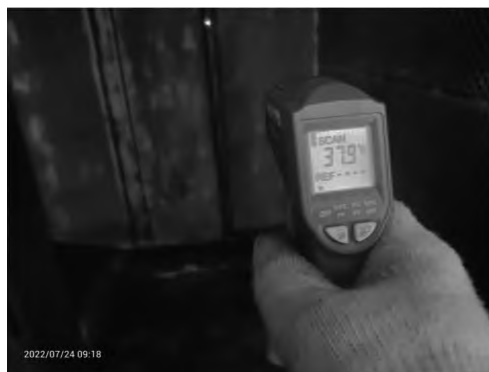
图3 红外测温枪监测物体表面温度
